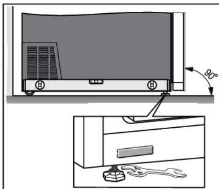
После установки в выбранном месте выровняйте прибор по уровню для уменьшения вибрации. Для выравнивания отрегулируйте высоту ножек в передней части прибора. Используйте гаечный ключ размера 17 для регулировки и фиксации ножек.
