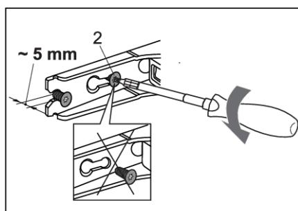
3. Не полностью (не более чем на 5 мм) открутите винты (2) верхнего и нижнего шарниров. Не откручивайте винты полностью. Так дверь будет прилегать к корпусу.
