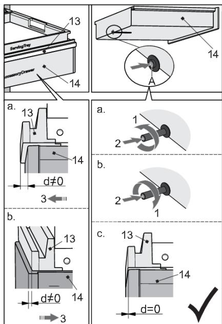
Если наклонная полка для бутылок (13) и ящик для аксессуаров (14) не выровнены спереди ( $d \neq 0$ ), сначала полностью выдвиньте ящик, чтобы получить доступ к механизму открывания ящика на его задней стенке. Нажмите на регулятор (A), чтобы освободить механизм. Вращайте регулятор, чтобы отрегулировать его длину.
