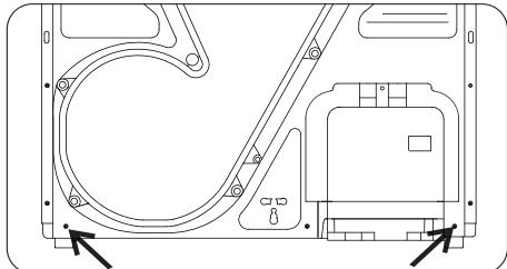
**5** Ослабьте регулировочные ножки в передней части сушильной машины в самом плотном состоянии на 3-4 оборота.
