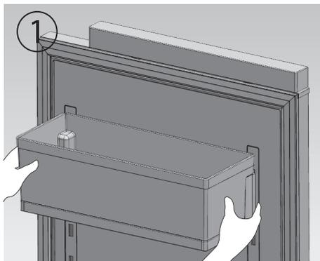
1. Для снятия дверной полки держите ее с обеих сторон двумя руками. Нажмите на нее сбоку без направляющей и протолкните в сторону, как показано на рисунке. Нажимайте до тех пор, пока край дверной стойки не выйдет из паза вкладыша.
