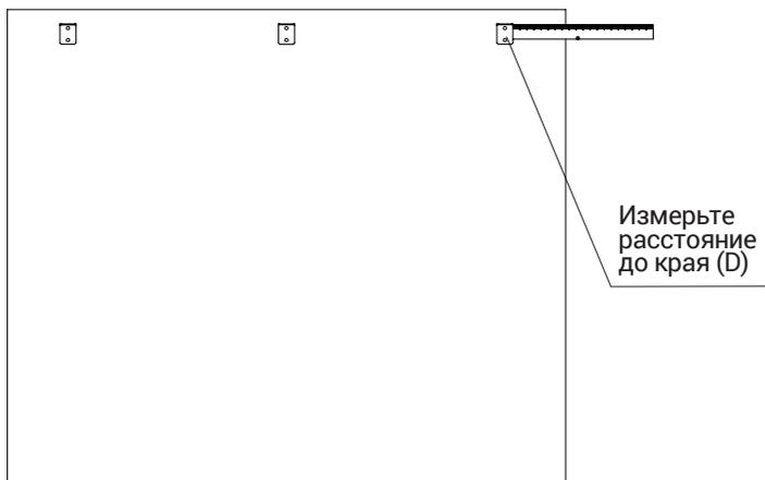
6. Приложите монтажную пластину, поместив в ограничительный паз крепежную пластину, установленную на фасадной панели морозильного ящика. Ползунок прислонен к боковой стороне дверцы шкафа. Установите крепежную пластину шкафа, соответствующий паз на монтажной пластине и закрепите крепежную пластину шкафа саморезом (рис. 14).
