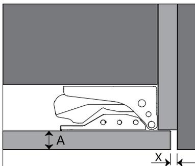
**Примечание:** зазор должен составлять 4 мм при толщине фасада 20 мм. Ширина дверной пластины фасада должна составлять 796 мм в варианте 1 или 794 мм в варианте 2.
