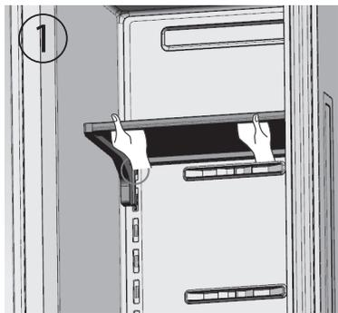
1. Стеклянные полки легко устанавливаются на разных уровнях. Для снятия потяните их на себя, затем опустите слегка вниз и извлеките.
