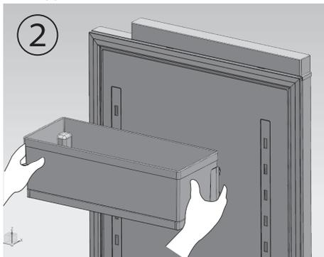
2. Для установки возьмите дверную полку с обеих сторон двумя руками. Сначала установите направляющую стороны. Затем слегка надавите на другую сторону внутрь, направляющая защелкнется на месте, и дверная полка будет установлена.
