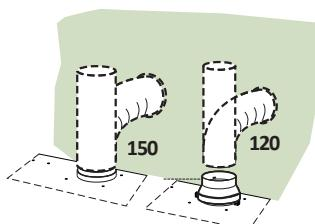
Para la instalación de la versión aspirante, conectar la campana al tubo de salida mediante un tubo rígido o flexible de ø150 o 120 mm, a discreción del instalador.
