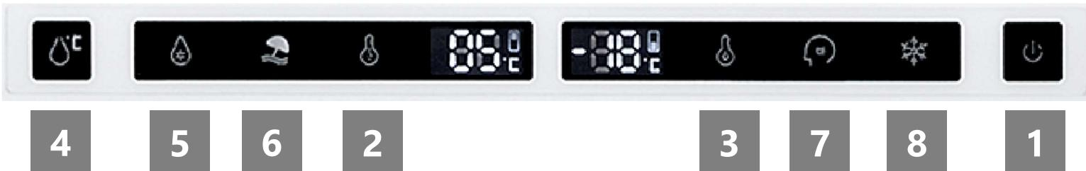
**1. Включение и выключение прибора.** Для включения или выключения нажмите на кнопку и удерживайте в течение 3 секунд.
