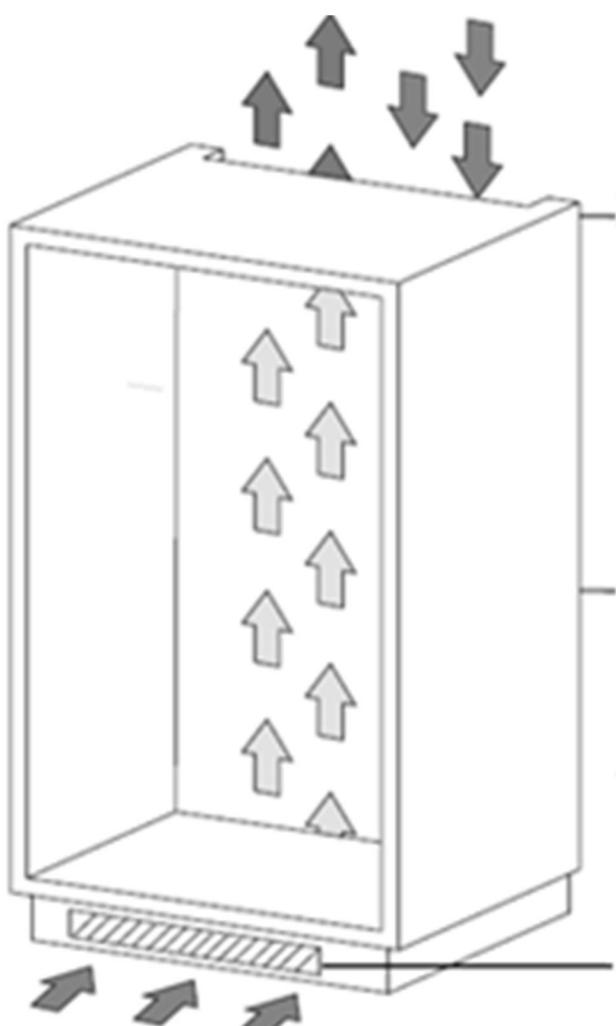
Сделайте зазор для вентиляции в верхней части шкафа. Воздушному потоку ничто не должно препятствовать.
