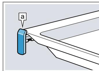
**Заметка:** В полностью выдвинутом положении направляющие фиксируются. Слегка нажмите на выдвигные направляющие при задвигании их обратно в рабочую камеру.
