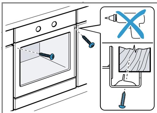
**Заметка:** Зазор между столешницей и прибором не должен быть закрыт дополнительной планкой. Запрещается устанавливать на боковых стенках шкафа для встраивания теплоизоляционные планки.
