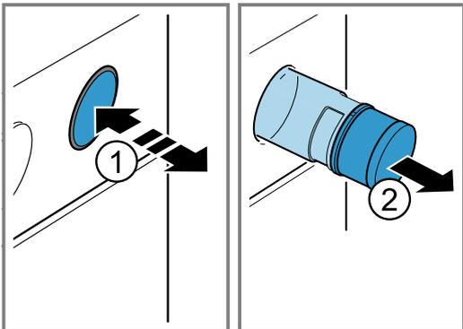
2. Нажмите на крышку резервуара для воды ① и открутите ②.
