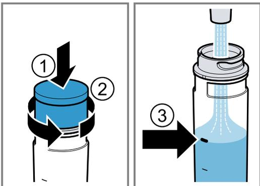
4. Нажмите на крышку резервуара для воды ① и прикрутите ②.
