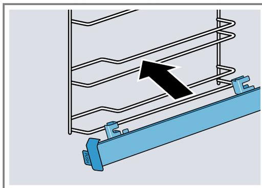
2. Вставьте крепление [a] сзади между нижним и верхним стержнями.
