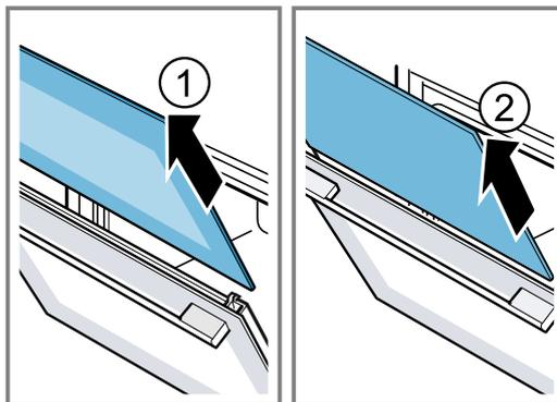
8. При необходимости планку для конденсата можно снять для очистки.
