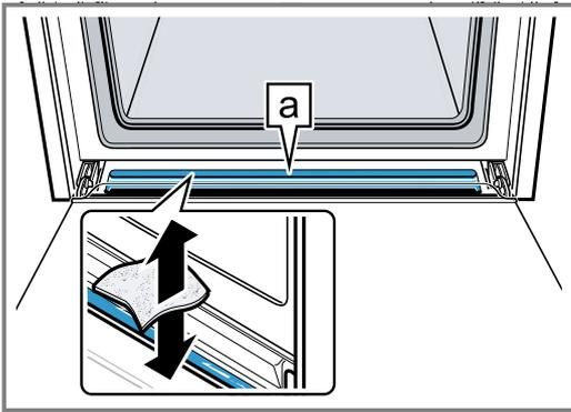
С помощью губки удалите воду из желоба для отвода конденсата **а** и аккуратно протрите его.
