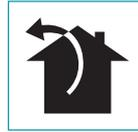
I denne versjonen blir røyk og damp ledet ut i det fri gjennom et avtrekksrør. Til dette formålet, må ventilatorhettens utløpskoping kobles med et rør til en ekstern utgang.
