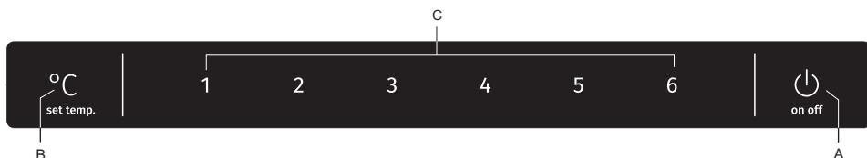
**A Кнопка вкл./выкл. прибора**
