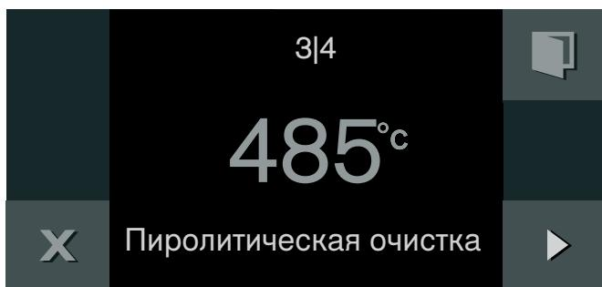
По завершении пиролитической очистки раздается сигнал. На дисплее появляется сообщение. После того, как прибор остынет, вытрите оставшийся в рабочей камере нагар влажной тряпочкой.
