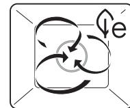
Данная программа особенно энергосберегающая. Воздух в камере прогревается нагревательным элементом, расположенным за задней стенкой камеры, и равномерно циркулирует. Влага, выделяемая продуктом, остается в камере. Приготовляемое блюдо не пересыхает.
