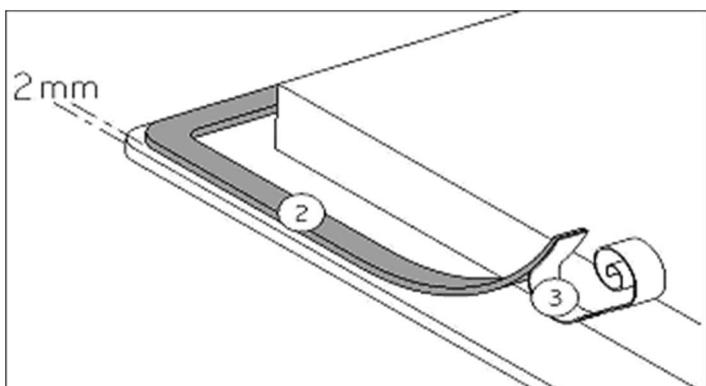
Приклейте уплотнение на расстоянии два (2) миллиметра от внешнего торца стеклокерамики, удалив защитный слой (3).
