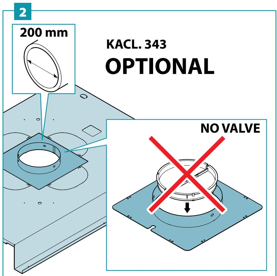
IT - Fissaggio tubo di aspirazione (3).
