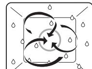
Воздух в камере прогревается нагревательным элементом, расположенным за задней стенкой камеры, и равномерно циркулирует. Влага, выделяемая продуктом, выводится из камеры в минимальном объеме. Влажность продукта сохраняется.
