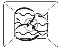
Воздух в камере прогревается нагревательным элементом, расположенным за задней стенкой камеры, и равномерно циркулирует. Дополнительная автоматическая обработка микроволнами сокращает время приготовления блюда.
