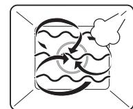
Камера нагревается горячим воздухом. Дополнительный автоматический обдув паром и обработка микроволнами обеспечивают более эффективную передачу энергии приготовляемому блюду и его ускоренное разогревание. Это сокращает процесс приготовления блюда.
