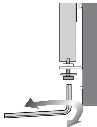
▶ **1)** Частично затянуть винты с гайками и шайбами. Гайки находятся между нижней частью ящика и уголком дверной панели.
