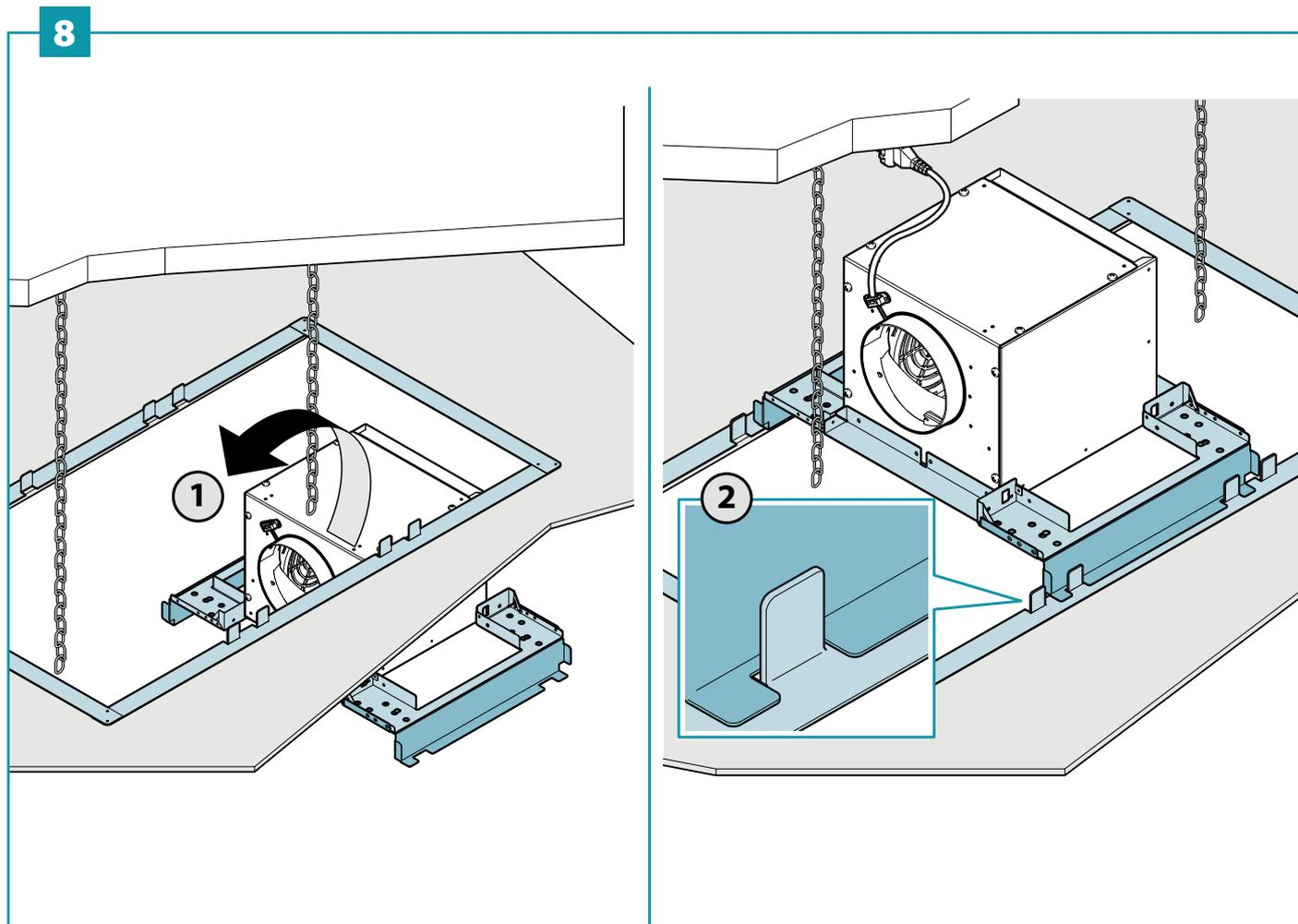
IT - Montaggio tubo d'aspirazione e collegamento elettrico (9).
