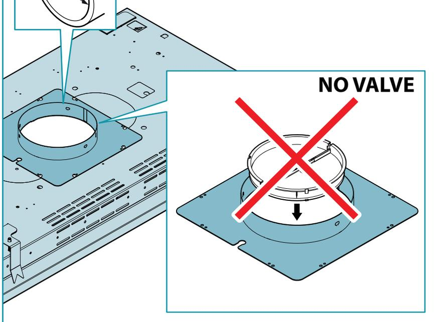
IT - Fissaggio tubo di aspirazione (3).
