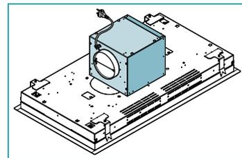
motor (2). Om luftutloppet är uppåt, se (3). För andra riktningar, se (4) och (5).
