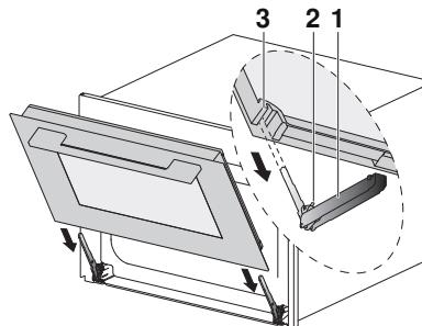
**⚠ Убедиться, что дверца прибора установлена до упора, в противном случае возможно повреждение прибора при закрывании дверцы.**
