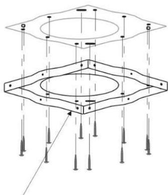
2. Просверлите отверстие  $\text{Ø } 170\text{mm}$  на потолке. Потолок должен выдерживать вес не менее 120кг и иметь толщину не менее 30см.
