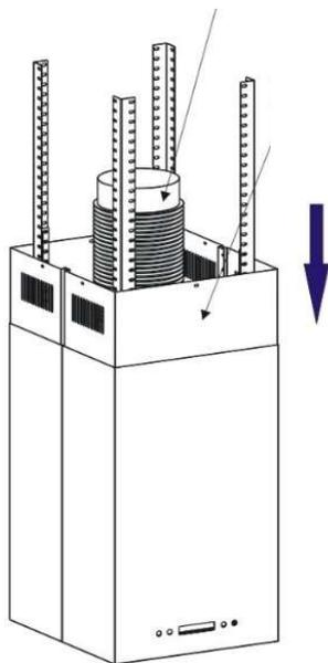
4. Соедините уголки и корпус вытяжки болтами и шайбами, затем зафиксируйте выходное отверстие и установите внутрь трубу (внутренний кожух должен входить в корпус вытяжки).
