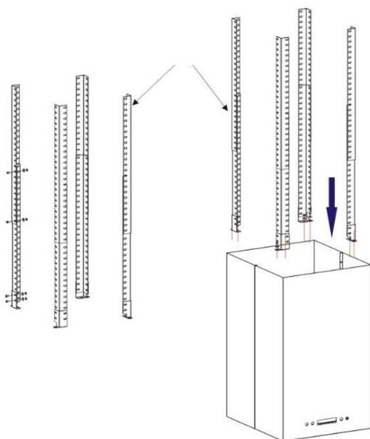
3. Просверлите отверстия в потолке согласно отверстиям в подвесном бруске. Прикрепите брусок к потолку с помощью дюбелей. Затем согласно размерам, посчитайте длину уголка металлического. Дюбели и гайки с прокладками используются для соединения уголка с другим уголком (длина нахлёста уголков не может быть менее 100мм)
