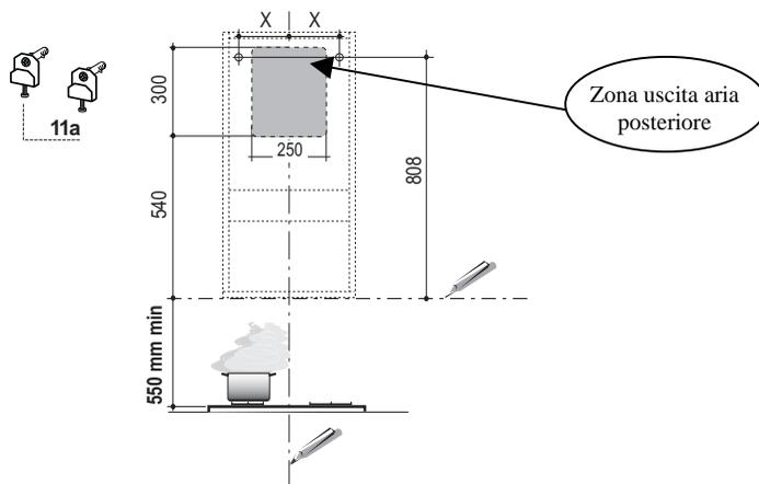
Nel caso di installazione della cappa in versione filtrante, tenere in considerazione che, sopra la cappa, deve rimanere una distanza dal limite superiore (Soffitto o Mensola) di almeno 8-10 Cm.
